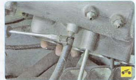
17. Приподнимите ресивер, ослабьте затяжку хомута...
