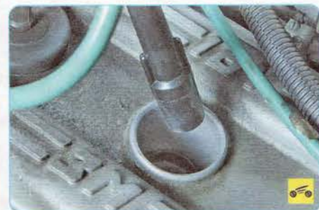
8. ...и отсоедините колодку от катушки зажигания.
