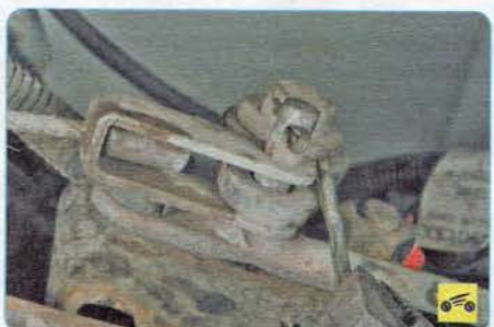
6. Извлеките шплинт крепления пальца тяги к рычагу.
