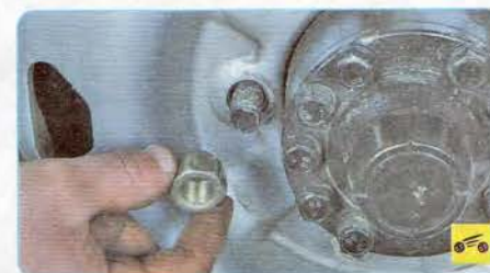
8. Обратной стороной ключа для гаек колес подденьте защитный колпак заменяемого колеса...
