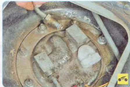
5. ...и отсоедините трубопроводы от топливного насоса.
