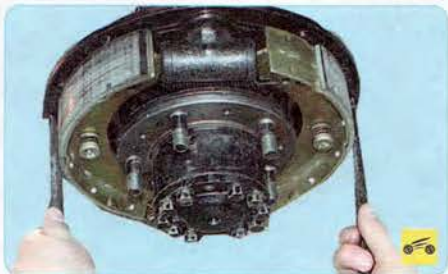
8. Сожмите тормозные колодки двумя монтажными лопатками и утопите поршни в рабочий цилиндр.
