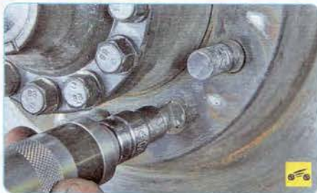
6. Отверните гайку крепления шарового пальца поперечной рулевой тяги к левому поворотному кулаку и снимите гайку.
