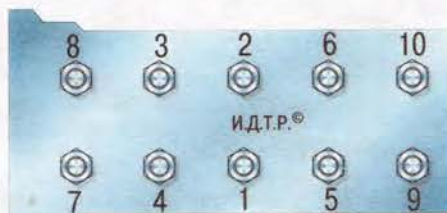
Рис. 5.9. Последовательность затяжки болтов крепления головки блока цилиндров
