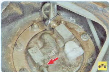
4. Отверните гайки крепления трубопроводов подачи и слива топлива...
