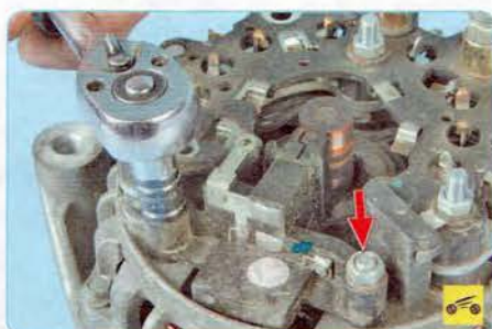
11. Отверните две гайки крепления щеткодержателя...
