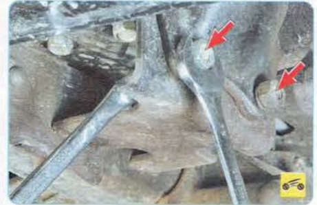
26. Отведите рулевой механизм от рамы и, опуская его вниз...
