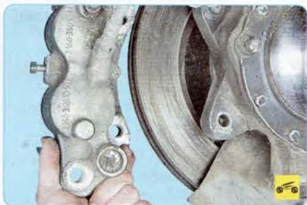
4. Снимите тормозную скобу в сборе с направляющей колодок, не отсоединяя тормозной шланг, и прикрепите его проволокой к деталям подвески, не допуская скручивания или натяжения шланга (см. «Замена корпуса рабочих цилиндров тормозного механизма переднего колеса», с. 211).
