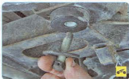
13. ...выверните и извлеките болт. Аналогичным образом извлеките второй болт.
