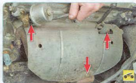
27. Выверните три болта крепления термомоэкрана...
