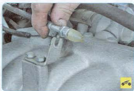
21. ...извлеките наконечник оплетки троса из кронштейна и отведите трос в сторону.
