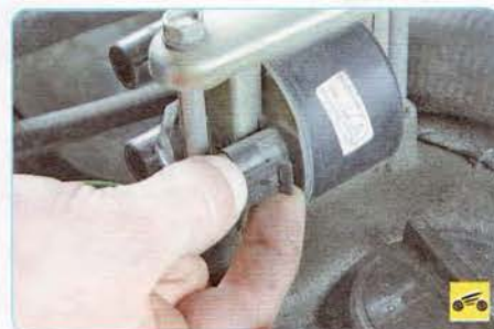
7. Сожмите фиксатор колодки жгута проводов...
