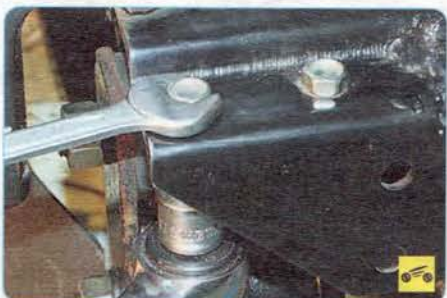
9. ...и заднего креплений кронштейна серьги рессоры и выньте болты.
