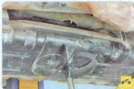
9. ...отведите хомуты в сторону и снимите топливный бак.
