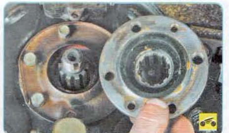
20. ...и снимите фланец с вала привода заднего моста.
