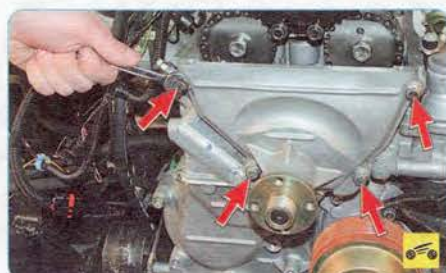
20. Выверните четыре болта и снимите переднюю крышку головки блока цилиндров в сборе с муфтой привода вентилятора и вентилятором (муфта вентилятора и вентилятор сняты для наглядности).
