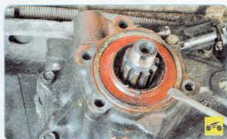
24. Отверткой извлеките сальник из гнезда крышки заднего подшипника.
