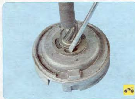
23. Поддев отверткой фиксирующее кольцо...
