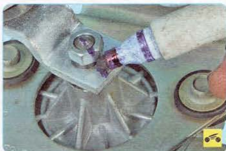
16. Промаркируйте положение левого рычага трапеции стеклоочистителя...
