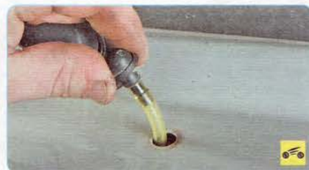
1. Поддев, извлеките форсунку стеклоомывателя...
