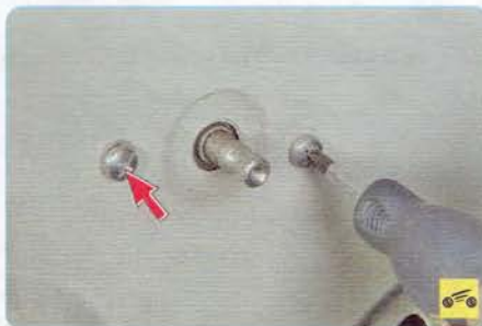
7. Выверните два винта крепления поворотного механизма внутренней ручки.
