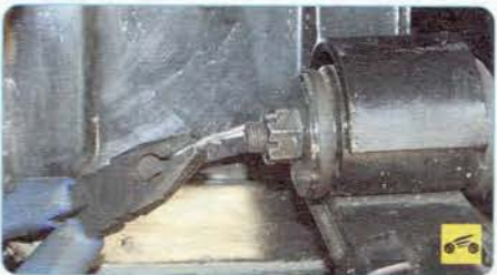
10. Расшплинтуйте гайку оси крепления переднего конца рессоры.
