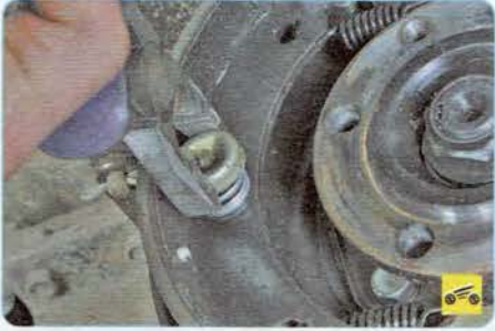
7. Поверните верхнюю чашку прижимной пружины на 90°...
