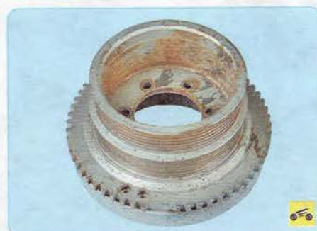
35. Снимите шкив коленчатого вала (см. «Замена сальников коленчатого вала», с. 78).
