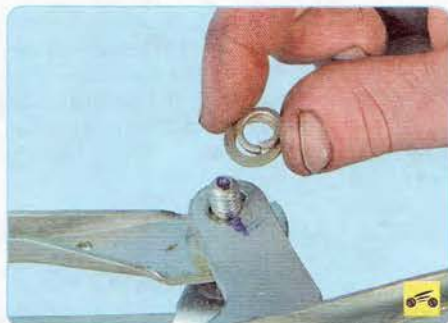
14. Снимите гайку, шайбу и прокладку.
