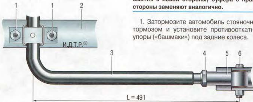
Рис. 7.1. Стабилизатор поперечной устойчивости: 1 – болт крепления скобы стабилизатора; 2 – рама; 3 – стабилизатор; 4 – контргайка регулировочного узла; 5 – регулировочный узел; 6 – болт крепления регулировочного узла
