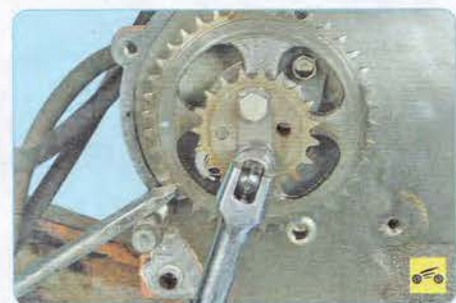
3. ...и выверните два болта, удерживающие промежуточный вал от проворачивания.
