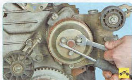
24. Придерживая шкив от проворачивания, выверните три болта...
