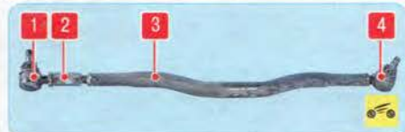
Рис. 8.4. Продольная рулевая тяга: 1 – передний наконечник рулевой тяги; 2 – регулировочный узел; 3 – продольная рулевая тяга; 4 – задний наконечник рулевой тяги
