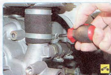
12. Ослабьте затяжку крепления хомута шланга термостата...
