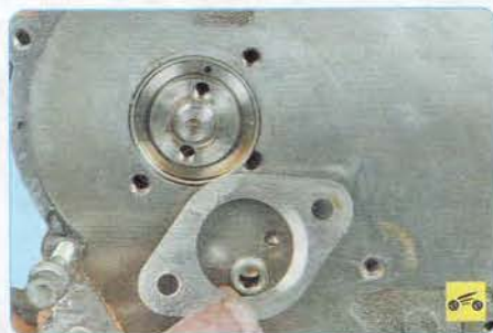
6. ...и снимите фланец промежуточного вала.
