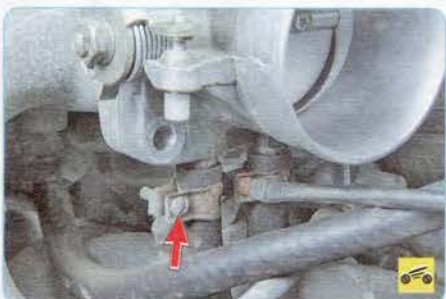
24. Ослабьте хомуты шлангов на дроссельном узле и отсоедините шланги.
