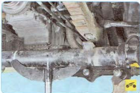
11. Немного опустите передний мост.
