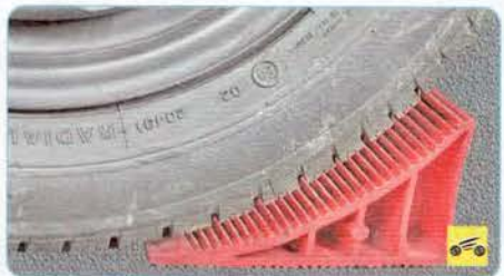
1. Затормозите автомобиль стояночным тормозом и установите противооткатные упоры («башмаки») под задние колеса.
