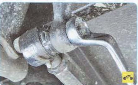
20. Отверните гайку крепления шарового пальца продольной рулевой тяги к рычагу рулевого механизма...
