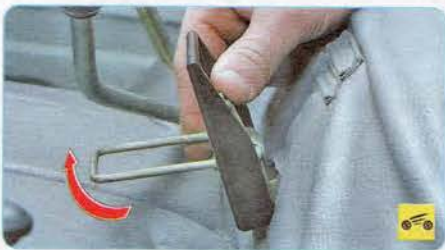
2. ...выведите фиксирующую скобу замка из паза...
