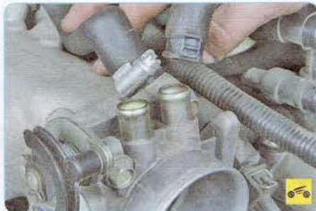
7. Ослабьте затяжку хомутов и снимите шланг регулятора холостого хода и шланг вентиляции картера.
