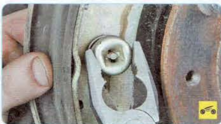
8. Сожмите тормозные колодки двумя монтажными лопатками и утопите поршни в рабочий цилиндр.
