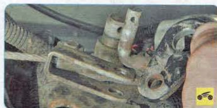
4. Снимите с пальца тяги рычаг и наконечник троса (см. «Замена троса привода стояночного тормоза», с. 217).
