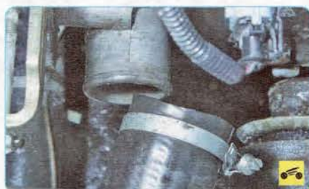
22. Ослабьте затяжку крепления хомута отводящего шланга радиатора...
