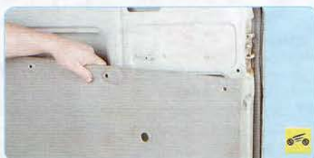
Рис. 11.2. Расположение пистонов крепления обивки задней боковой двери
