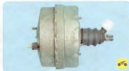
Вакуумный усилитель, установленный между механизмом педали и главным
