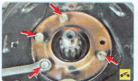
21. Выверните четыре болта крепления маслоотражателя к крышке заднего подшипника вала...
