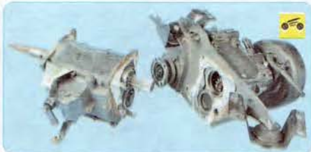
29. ...а затем снимите коробку передач.
