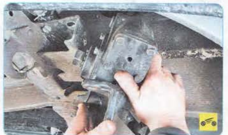
29. ...и переднего крепления рулевого механизма к раме.
