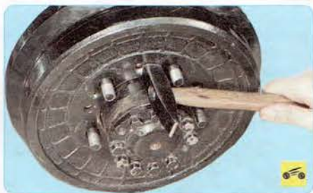
4. Обстучите молотком тормозной барабан.
