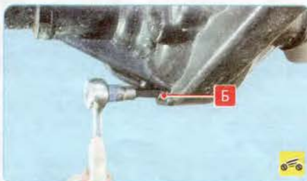
...и пробка Б отверстия для слива масла на мосту с неразъемным картером...
