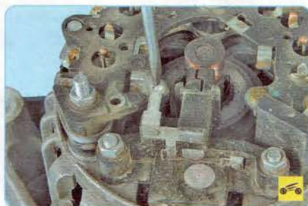
10. Выверните винт крепления клеммы щеткодержателя.
