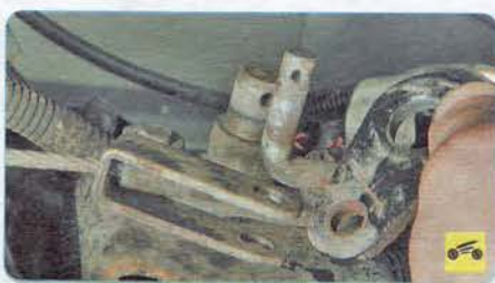
9. Снимите с пальца тяги рычаг и наконечник троса.
