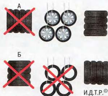
Рис. 13.6. Способы хранения шин: А – хранение колес в сборе с шинами; Б – хранение шин
