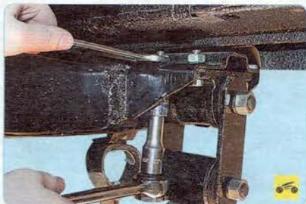
8. Удерживая болты от проворачивания, отверните по две гайки переднего...
