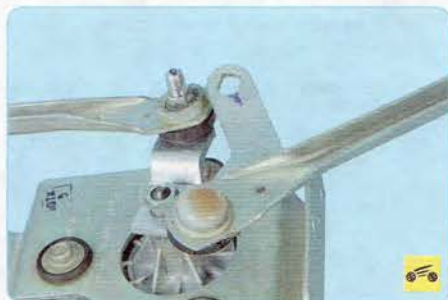
15. Снимите правый рычаг трапеции стеклоочистителя.
