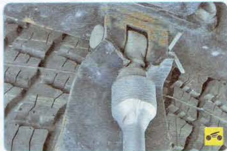
4. Ослабьте затяжку гайки держателя...
