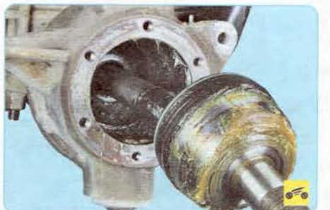
17. Извлеките из картера моста полуось в сборе со ШРУСом.
