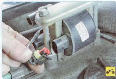
8. ...и отсоедините колодку от катушки зажигания.
