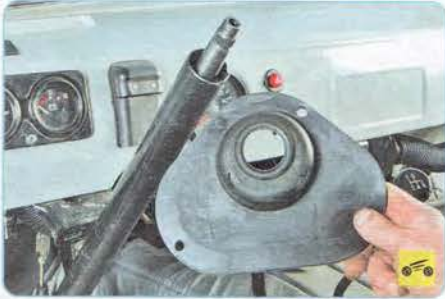
16. ...и уплотнитель корпуса рулевого вала.
