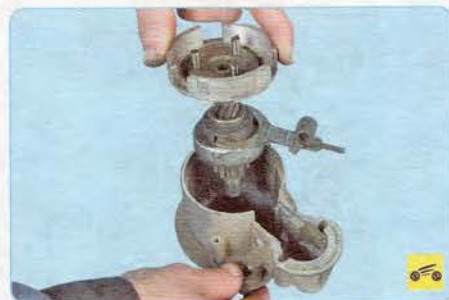
18. Выньте редуктор с приводом из передней крышки стартера.
