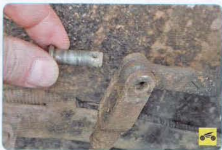
4. Извлеките палец вилки из отверстий.
