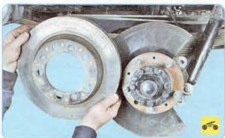
5. Снимите тормозной диск (см. «Замена тормозного диска тормозного механизма переднего колеса», с. 212).
