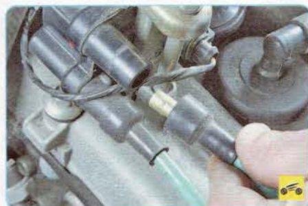
5. Отсоедините провод высокого напряжения 3-го...
