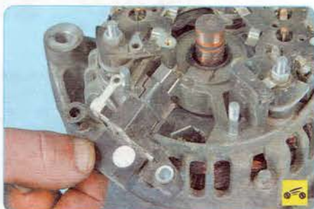
12. ...и снимите щеткодержатель в сборе с регулятором напряжения.
