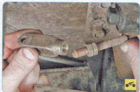
5. Свинтите с наконечника троса вилку и контргайки.
