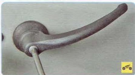
1. Выверните винт крепления внутренней ручки...
