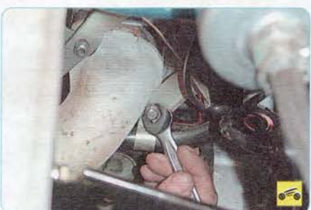
25. Отверните крайнюю правую гайку выпускного коллектора..
