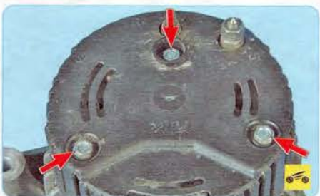
8. Отверните три гайки крепления...
