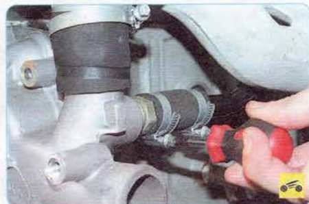
30. ...и шланга трубки забора воды.
