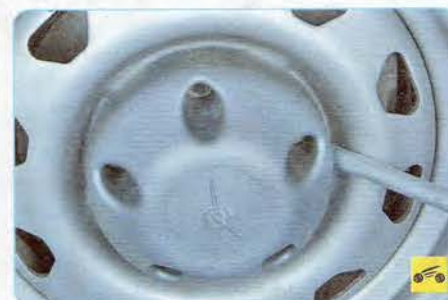
8. Обратной стороной ключа для гаек колес подденьте защитный колпак заменяемого колеса...
