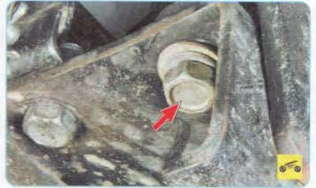
28. ...и переднего крепления рулевого механизма к раме.
