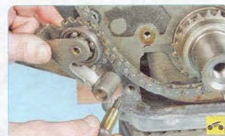
41. Аналогично снимите нижний рычаг натяжного устройства со звездочкой.
