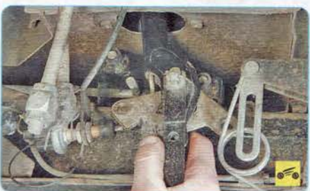
7. ...и снимите рычаг стояночного тормоза, выводя наконечник тяги из отверстия в рычаге.
