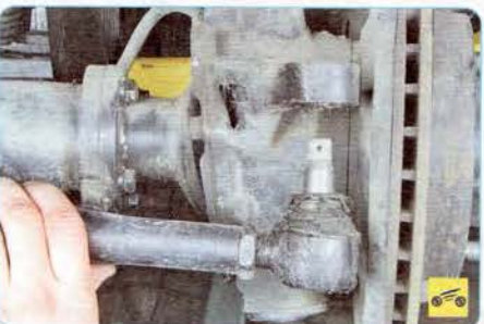
8. Выпрессуйте палец из отверстия поворотного кулака и отсоедините поперечную рулевую тягу от рычага поворотного кулака.
