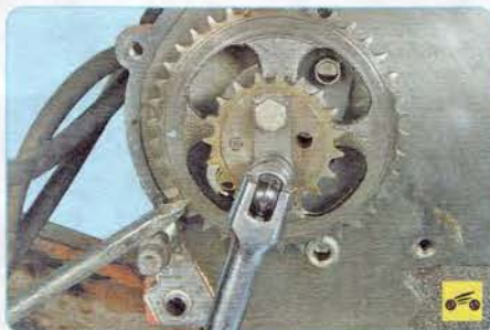
50. ...и выверните два болта, удерживая промежуточный вал от проворачивания.
