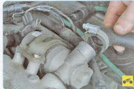
12. ...и снимите воздухоподводящий шланг с регулятора холостого хода.
