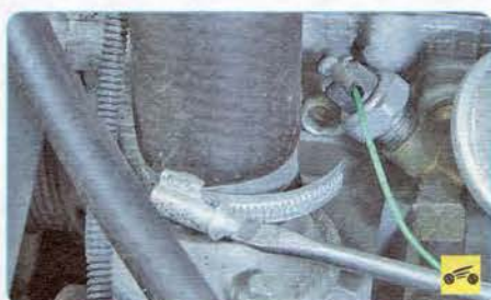
17. Ослабьте затяжку хомута подводящего шланга...
