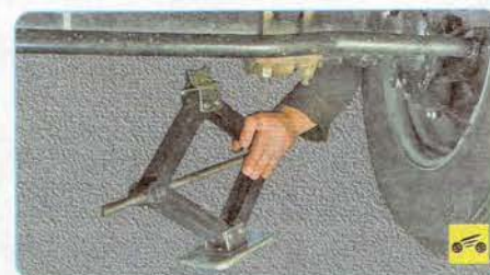
12. Установите домкрат под мост, около рессоры поднимаемой стороны (см. «Пользование домкратом», с. 31).
