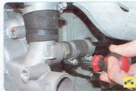
13. ...и шланга трубки забора воды.
