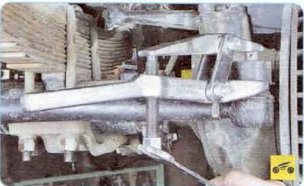
7. Установите съемник шаровых шарниров.
