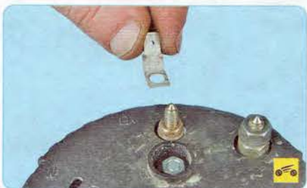
7. ...и снимите клемму с вывода обмотки возбуждения генератора.
