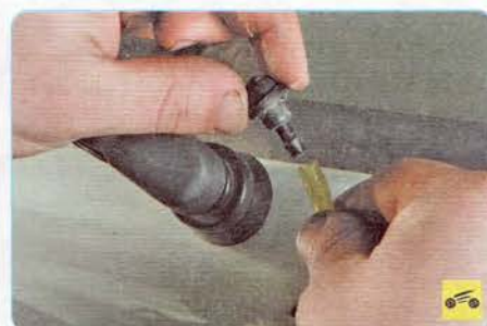
2. ...и отсоедините ее от шланга подачи жидкости. Аналогично снимите вторую форсунку стеклоомывателя.
