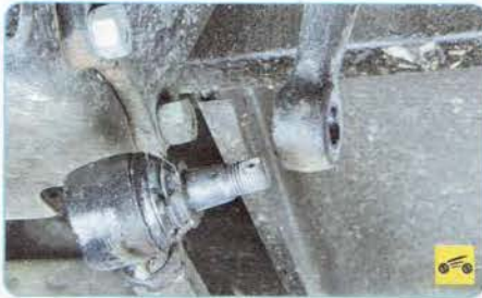
22. Установите съемник шаровых шарниров и выпрессуйте палец из отверстия рычага рулевого механизма.
