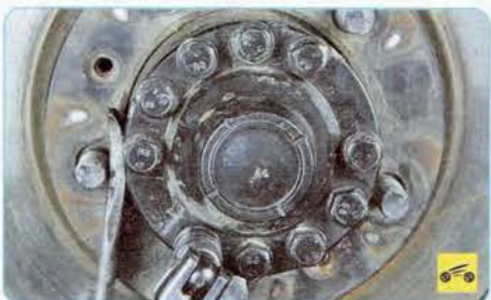
6. Выверните десять болтов крепления крышки ступицы переднего колеса...
