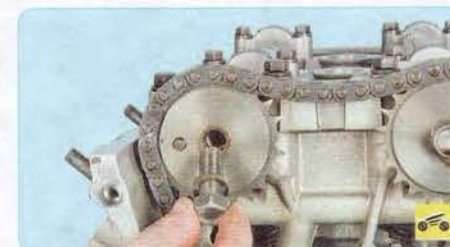
43. Снимите шестерни с распределительных валов, вывернув болты крепления
