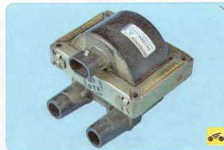
12. Установите катушку зажигания в порядке, обратном снятию.
