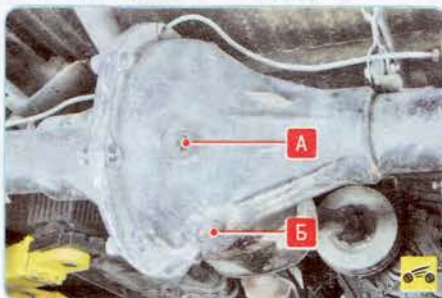
...а так расположены эти пробки на картере моста с вертикальным разъемом.
