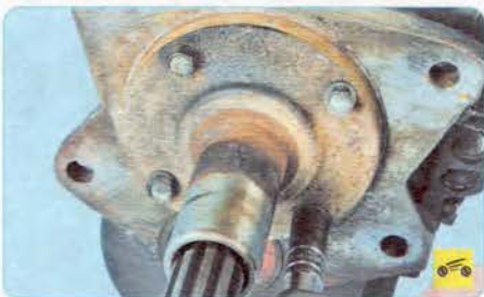
2. Выверните четыре болта крепления передней крышки к картеру коробки передач.
