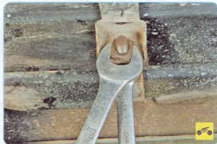
8. Удерживая от проворачивания, отверните гайки болтов крепления двух хомутов топливного бака...
