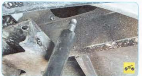
30. ...и переднего крепления рулевого механизма к раме.
