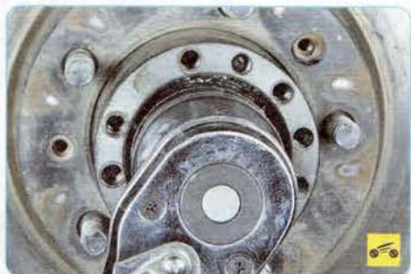
12. Отверните гайку подшипников ступицы.
