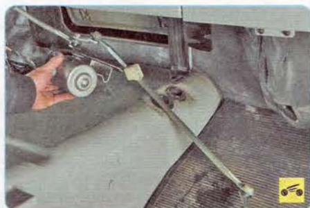
11. ...и извлеките трапецию из кабины.
