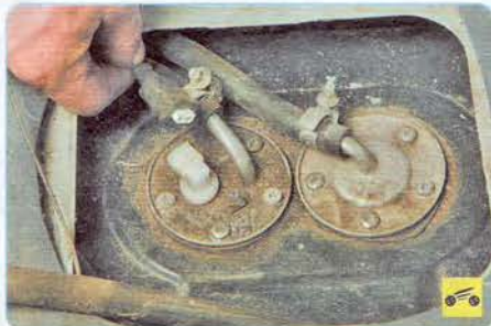
5. ...и отсоедините трубопроводы от топливного насоса.
