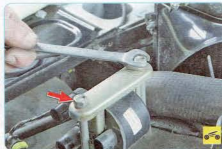
9. Выверните два болта крепления прижимной скобы катушки зажигания.
