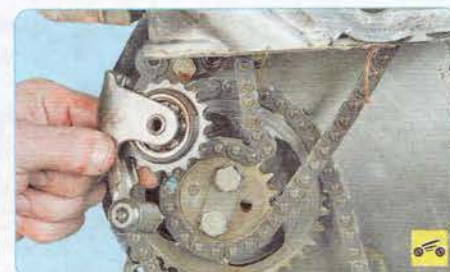
40. Выверните болт верхнего рычага натяжного устройства и снимите рычаг натяжного устройства со звездочкой.
