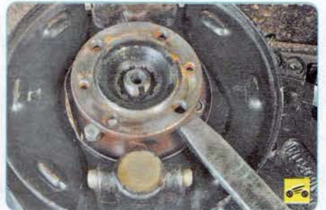
19. С помощью монтажной лопатки выпрессуйте фланец вала привода заднего моста со шлицев...
