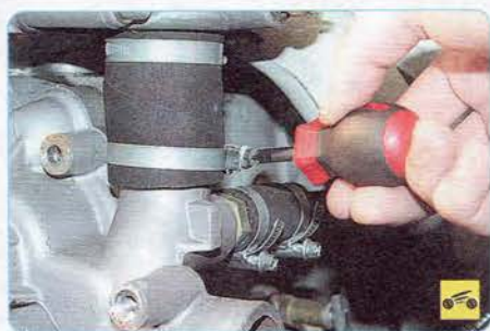
29. Ослабьте затяжку крепления хомута шланга термостата...
