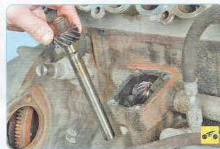
9. Выньте вверх привод масляного насоса с ведомой шестерней.
