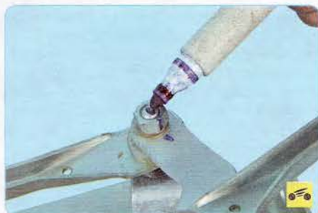
12. Промаркируйте положение правого рычага трапеции стеклоочистителя...
