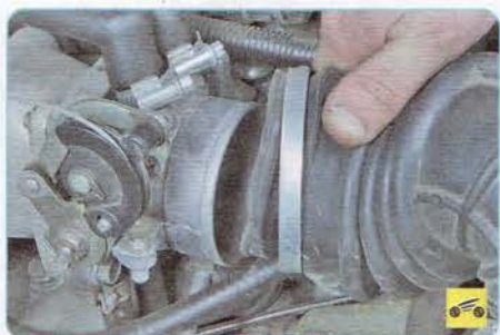
18. Ослабьте затяжку хомута крепления воздухоподводящего шланга, снимите шланг и отведите его в сторону.
