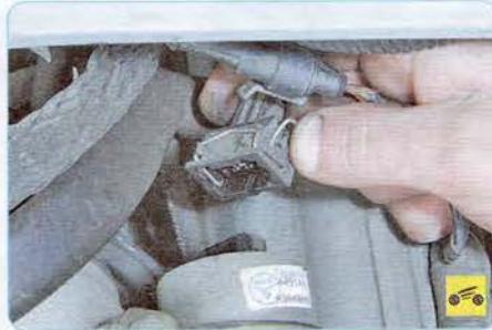
10. Отсоедините колодку жгута проводов от регулятора холостого хода.
