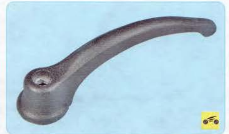
11. ...и внутреннюю ручку привода замка передней двери в порядке, обратном снятию.
