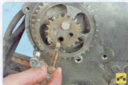
50. ...и выверните два болта, удерживая промежуточный вал от проворачивания.
