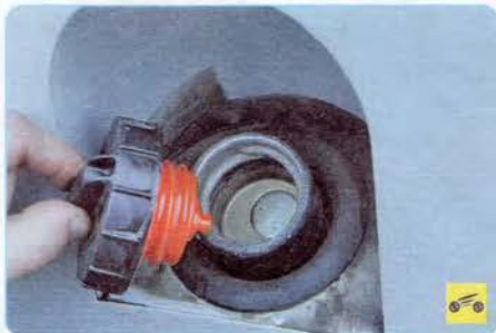
2. Выверните крышку и снимите ее с наливной горловины топливного бака.
