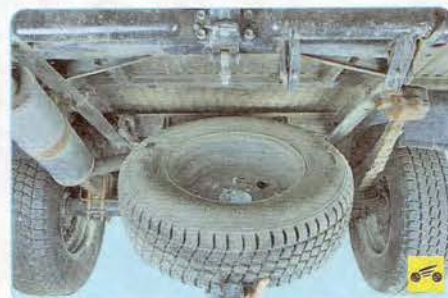
6. Опустите вниз держатель с запасным колесом, выньте запасное колесо из места его крепления и положите его рядом с заменяемым колесом.
