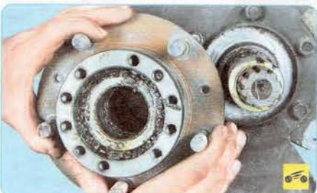
12. Снимите ступицу переднего колеса (см. «Снятие и установка ступицы переднего колеса», с. 171).
