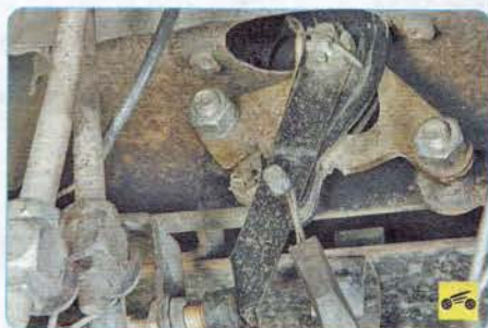
5. Извлеките шплинт пальца крепления тяги к рычагу.
