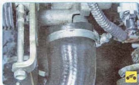
22. Ослабьте затяжку крепления хомута отводящего шланга радиатора...
