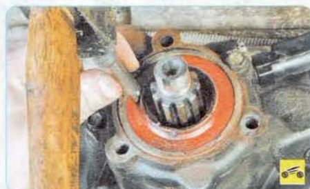
25. Смажьте кромку нового сальника консистентной смазкой и запрессуйте сальник в корпус крышки. При установке сальника избегайте перекосов.
