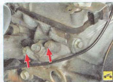
37. Выверните два болта и снимите крышку гидронатяжителя верхней цепи с прокладкой. Крышку снимайте осторожно, так как на нее воздействует пружина гидронатяжителя (см. «Снятие и разборка гидронатяжителей», с. 71).
