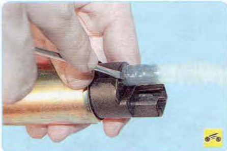
16. ...подденьте отверткой и снимите с него трубку подачи топлива в систему.
