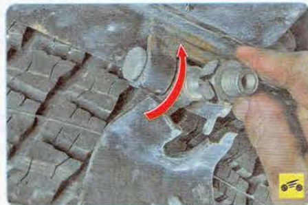
5. ...и, придерживая рукой держатель запасного колеса, откиньте болт, высвобождая его из паза держателя.
