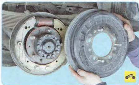
7. Снимите тормозной барабан.
