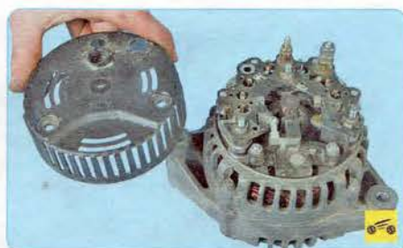
9. ...и снимите защитный кожух.
