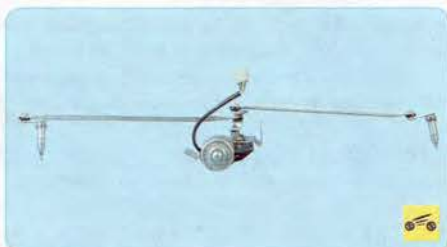
20. Соберите трапецию стеклоочистителя и установите ее в порядке, обратном снятию.
