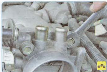
8. Выверните четыре болта крепления дроссельного узла к ресиверу...
