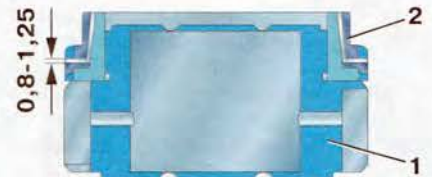
Рис. 6.13. Шестерня III передачи с притертым блокирующим кольцом: 1 – шестерня III передачи; 2 – блокирующее кольцо
