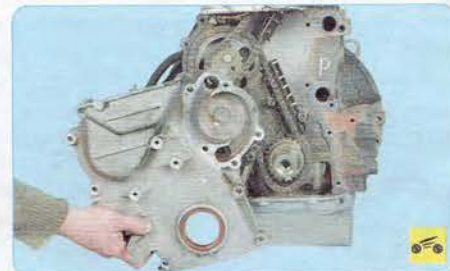
39. Выверните семь болтов и снимите крышку цепи. Крышку снимайте осторожно, чтобы не повредить установленный в ней передний сальник коленчатого вала, прокладку крышки и прокладку головки блока цилиндров.
