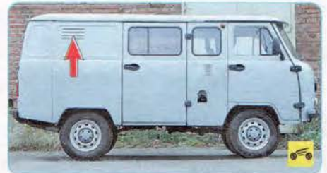
Вытяжная вентиляция грузового, пассажирского или грузопассажирского отсека осуществляется через жалюзи с правой...
