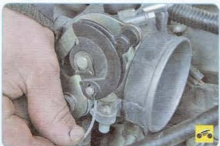
19. Отсоедините конец троса от сектора привода дроссельной заслонки.
