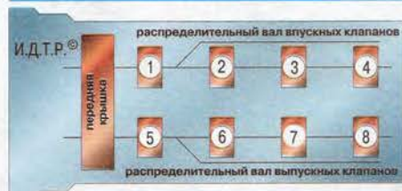
Рис. 5.5. Схема установки крышек распределительных валов двигателя ЗМЗ-409
