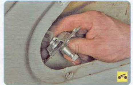
9. ...и отсоедините от него тягу привода замка.
