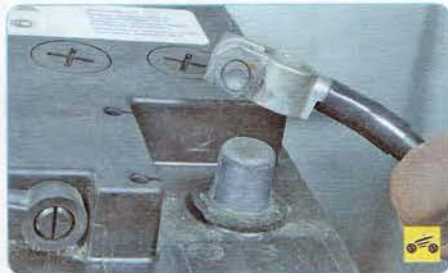
4. Отсоедините провод от клеммы «минус» аккумуляторной батареи.
