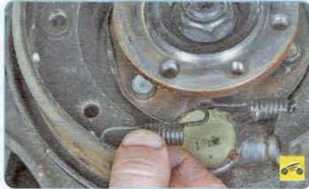
12. Извлеките второй конец из колодки и снимите нижнюю стяжную пружину.
