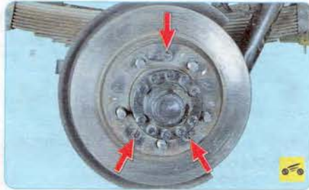
10. Выверните три винта крепления тормозного диска к ступице.
