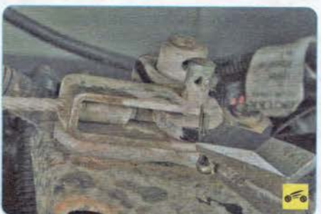
7. Аналогично извлеките шплинт пальца крепления рычага.
