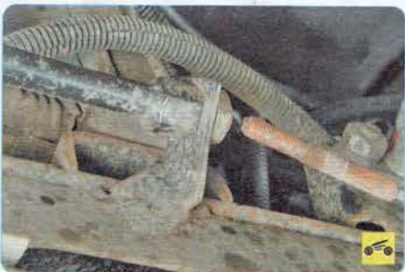
10. Проденьте трос через защитную трубку и снимите его.
