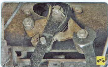
6. Отверните две гайки крепления рычага...
