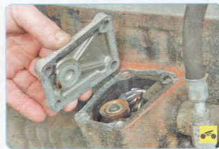
8. ...и снимите крышку с прокладкой.
