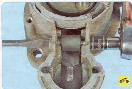
16. Удерживая ось рычага от проворачивания, отверните гайку...
