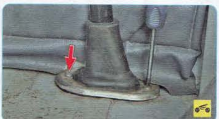
1. В салоне выверните два винта крепления фиксирующего кольца уплотнителя рычага...
