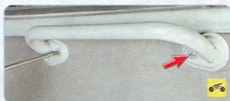
Рис. 11.2. Расположение пистонов крепления обивки задней боковой двери
