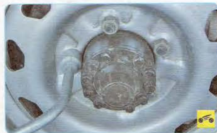
10. Ослабьте затяжку гаек крепления колеса.
