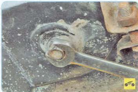
3. Для удаления остатков топлива выверните пробку сливного отверстия бака и слейте из него остатки топлива.
