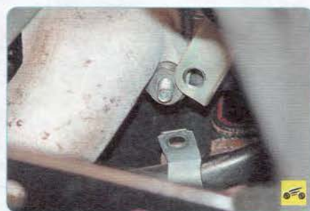
26. ...и снимите со шпильки держатель трубопровода системы охлаждения.
