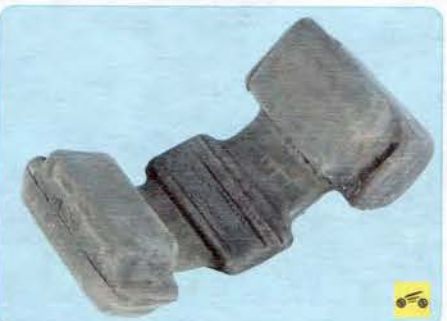
14. Осмотрите резиновые подушки, поврежденные подушки замените.
